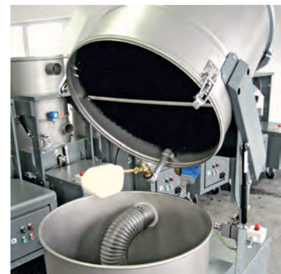
Abkippbares Geräteoberteil für einfachen Zugang ins Innere
