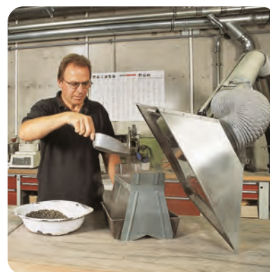
Quadratische Haube mit Prallblech an einer Wiegestation
