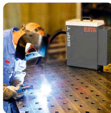
SRF T-2, Direktabsaugung an einem Schweißbrenner
