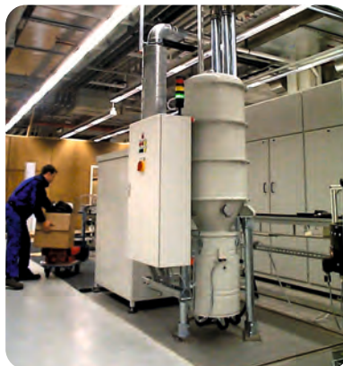
Filterzyklon FZ-1003 mit 100 Liter Sammelbehälter
