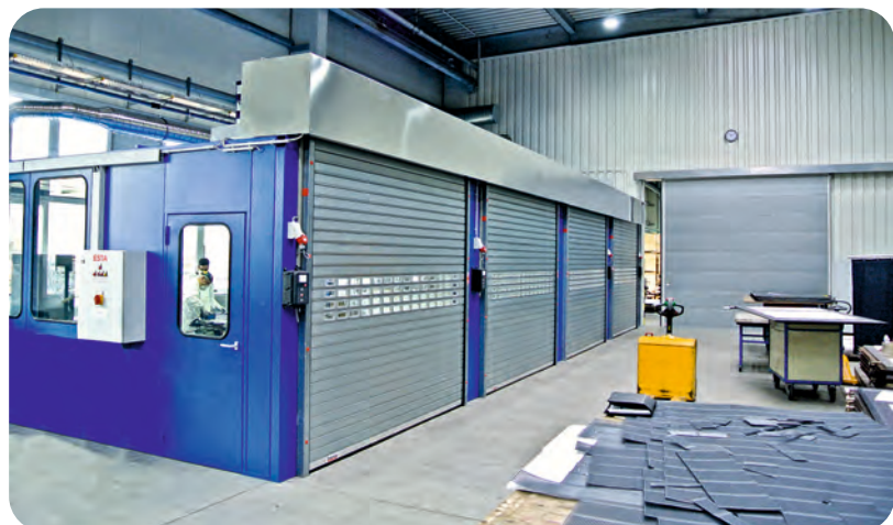
4-fach Schleifkabine mit Rolltoren
