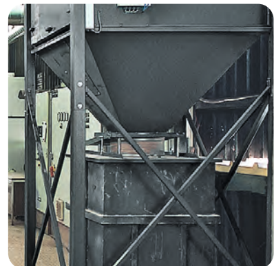
Austrag in einen Container, der dicht mit der Filtereinheit verbunden ist (optional)
