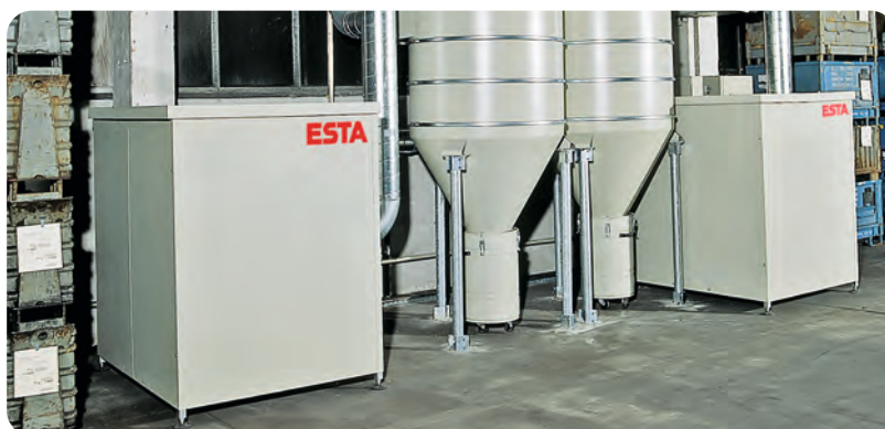
Hochdruckventilatoren in Verbindung mit zwei ESTA-Filterzyklonen
