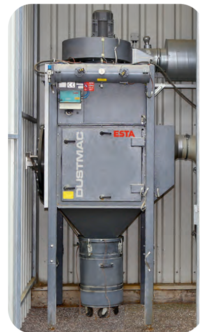
Absauganlage DUSTMAC F in der Chemie-Industrie
