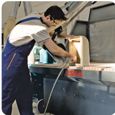
Absaugtisch mit Holzplattenrost und Absaugarm
