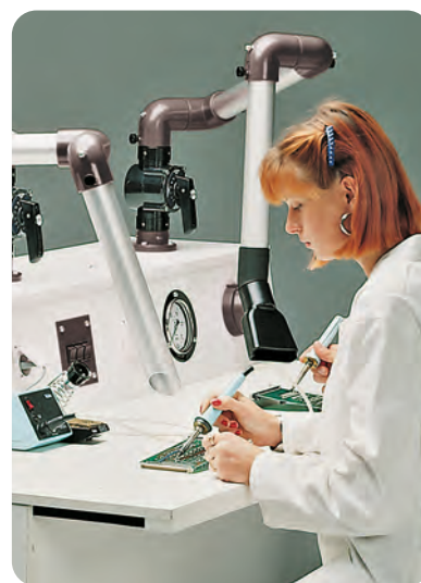
Mehrere Absaugarme für die Absaugung von Lötrauch
