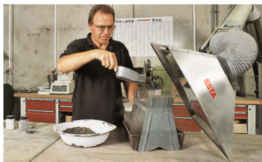
Absaugarm mit quadratischer Haube für die großflächige Absaugung von Staub bei einem Umfüllprozess in der Schüttgutindustrie
