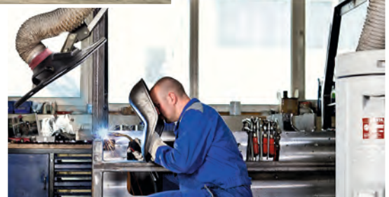
Absaugarme mit Effizienzhaube zur punktgenauen Erfassung von Schweißrauch
