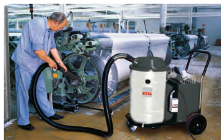
ESTA DUROSOG mit 3,0m langem, antistatischem Saugschlauch und Schrägrohrdüse zur Absaugung von Textilfasern
