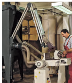
Absaugarm mit Düsenhaube bei einer Schleifanwendung
