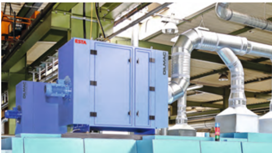
Ölnebelabscheider OILMAC 3000 auf einer Bearbeitungsmaschine
